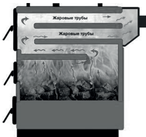
Рис. 5. Котел VULKAN SR 20-100, схема движения дымовых газов.
