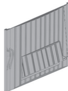
Рис.3. Регулировочная дверца подачи первичного воздуха
