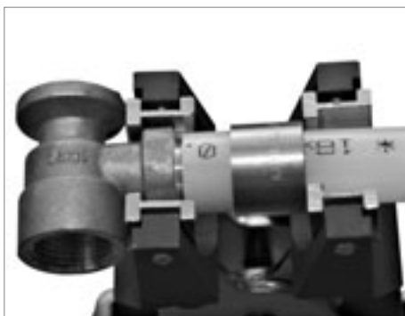
Монтаж отводов фиксируемых латунных
