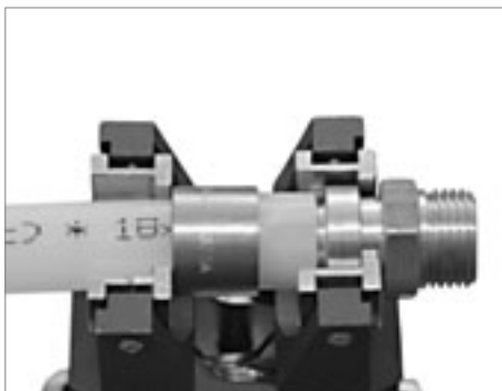
Монтаж соединителей с наружной и внутренней резьбой \varnothing 14 \times 2 , \varnothing 18 \times 2 , \varnothing 18 \times 2,5
