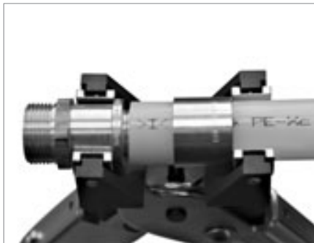
Монтаж соединителей с наружной и внутренней резьбой \varnothing 25 \times 3,5
