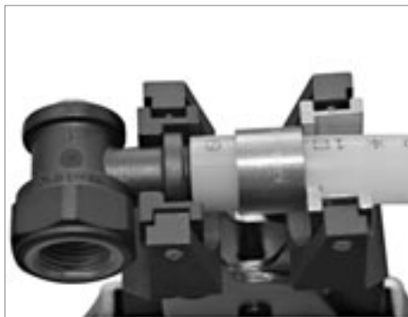
Монтаж отводов фиксируемых из PPSU
