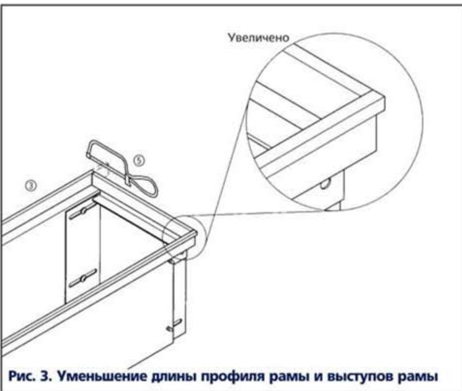
Рис. 3. Уменьшение длины профиля рамы и выступов рамы
