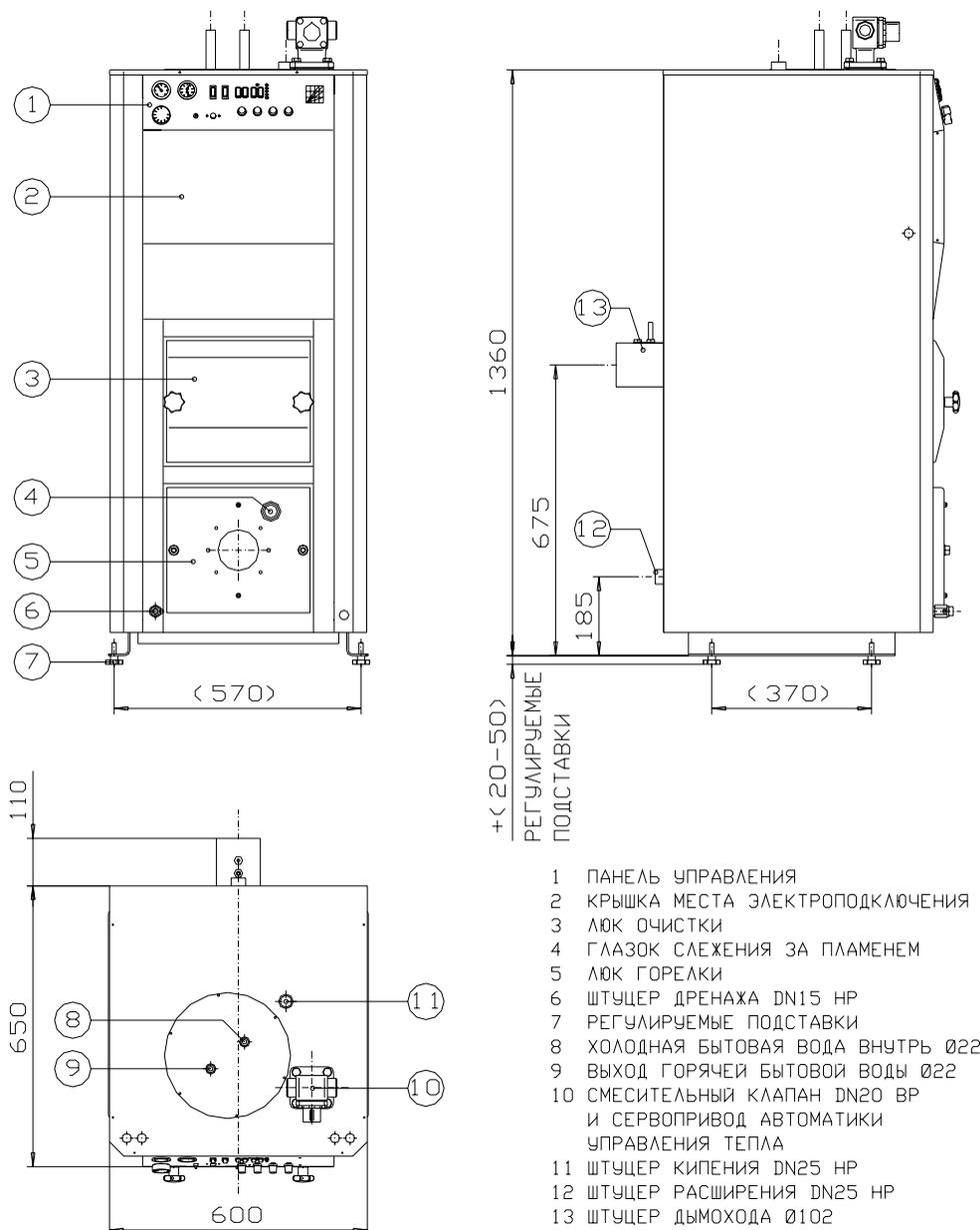
Рис. 1 Технические данные и размеры котла
