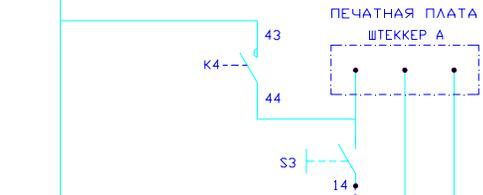
S3= ВЫКЛЮЧАТЕЛЬ ГОРЕЛКИ
