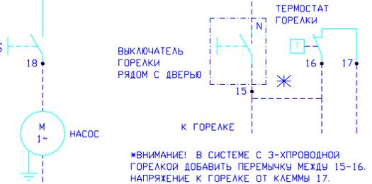
\*ВНИМАНИЕ! В СИСТЕМЕ С 3-ХПРОВОДНОЙ ГОРЕЛКОЙ ДОБАВИТЬ ПЕРЕМЫЧКУ МЕЖДУ 15-16. НАПРЯЖЕНИЕ К ГОРЕЛКЕ ОТ КЛЕММЫ 17.
