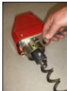
13. Вверните внутренний зажимной винт в просверленное отверстие.
