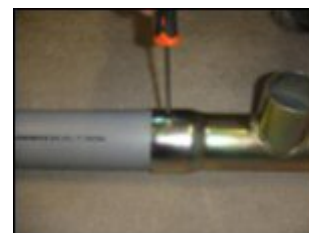
17. Закрепите пластиковую трубу с помощью винта в комплекте.
