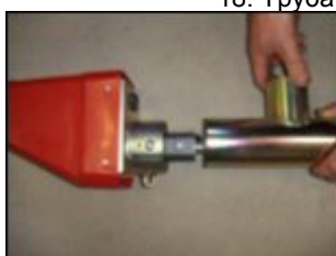
19. Наденьте трубу шнека на спираль и зафиксируйте на месте так, чтобы выпускное отверстие тройника было направлено в сторону соединения на двигателе.
