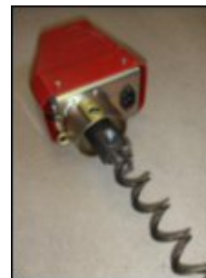
14. Спираль в соединении с двигателем.
