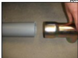
15. Совместите тройник с пластиковой трубой с конца, противоположного тому, на котором вы высверлили внутреннее отверстие.
