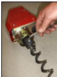
12. Заверните наружный зажимной винт.
