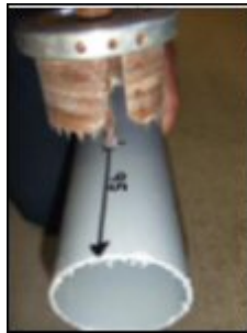
2. Возьмите пилу для выпиливания отверстий диаметром 90 мм.
