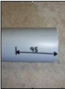
1. Отмерьте 95 мм от края трубы шнека.
