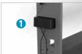
Приклейте контроллер на крепление
