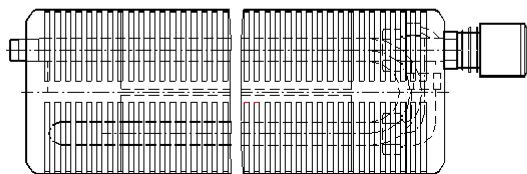
Рис.2 Конвектор «НовоТерм» напольный сдвоенный СКД 200Т2–Л с терморегулирующим клапаном для двухтрубных систем отопления и левосторонним подключением.
