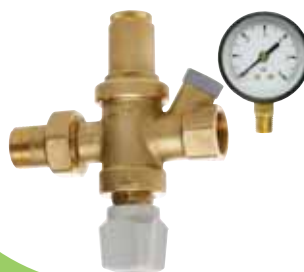
Арт. 250 + 244 Подпиточный клапан. С отсекающим краном и фильтром. В комплекте с обратным клапаном и манометром. Боковые подключения к манометру: 1/4 газ. Максимальное давление: на входе - 10 бар на выходе - 3 бар Фабричная настройка: 1,5 бар.
