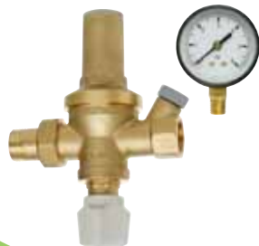
Арт. 249 + 243 Подпиточный клапан. С отсекающим краном и фильтром. В комплекте с обратным клапаном и манометром. Боковые подключения к манометру: 1/4 газ. Максимальное давление: на входе - 16 бар на выходе - 6 бар Фабричная настройка: 1,5 бар.
