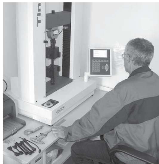
Фото 4.2.8. Испытания стыковых сварных соединений в лаборатории ИКАПЛАСТ
