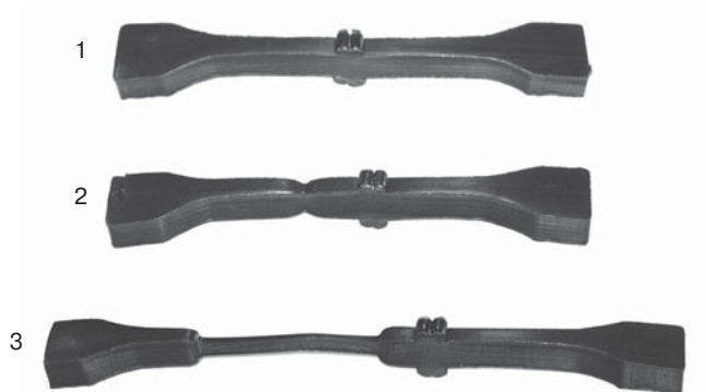
Фото 4.2.9. Образец с фрагментом стыкового сварного соединения (1).
