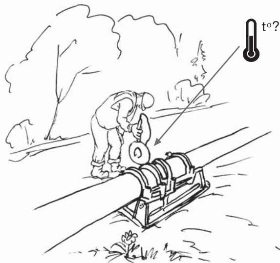
Рис. 4.2.9. Контроль температуры на поверхности нагревателя
