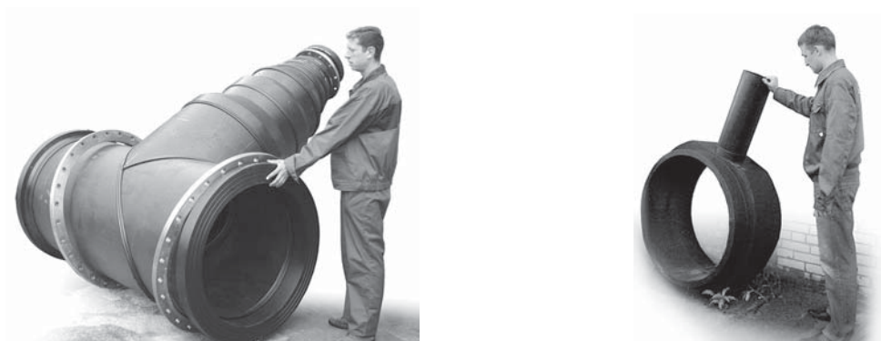
Фото 4.2.3. Примеры соединительных деталей и узлов ИКАПЛАСТ, выполненных сваркой встык. Слева: неравнопроходной тройник 900 x 200 SDR17 ПЭ 100. Справа: тройник ИКАПЛАСТ с монолитным корпусом 1000 x 225 SDR17 ПЭ 100
