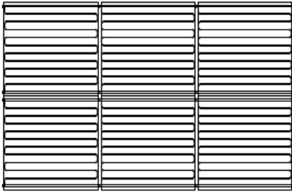
Пример 6 коллекторов FKF 240 Н в 2 ряда Ширина поля: 6307 мм Высота поля: 2334 мм
