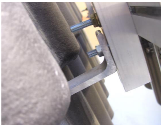
Рисунок 20: Монтаж прижимной рейки
