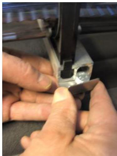
Рисунок 32: Выравнивание прижимной рейки и угла
