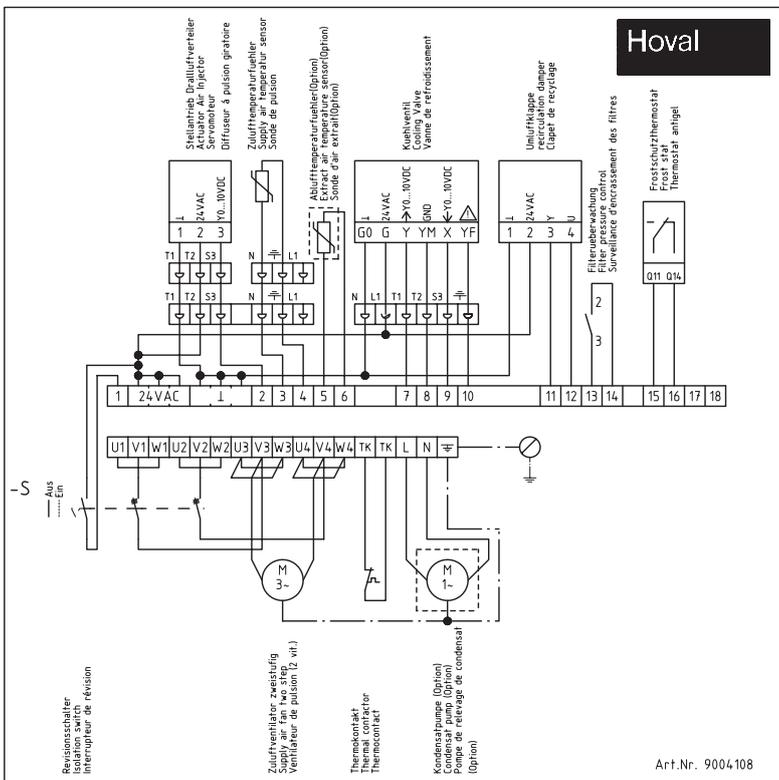
**Рис. 7. Электрическая схема простой контактной коробки для агрегата TopVent® commercial AU**
