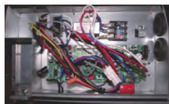
Плата управления внутреннего блока
