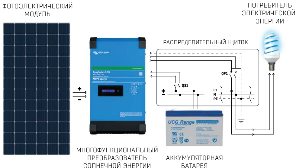
Рисунок 1.1 Блок-схема по подключению оборудования системы
