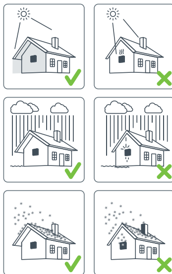
Рисунок 3.4.2 Установка инвертора на поверхность
