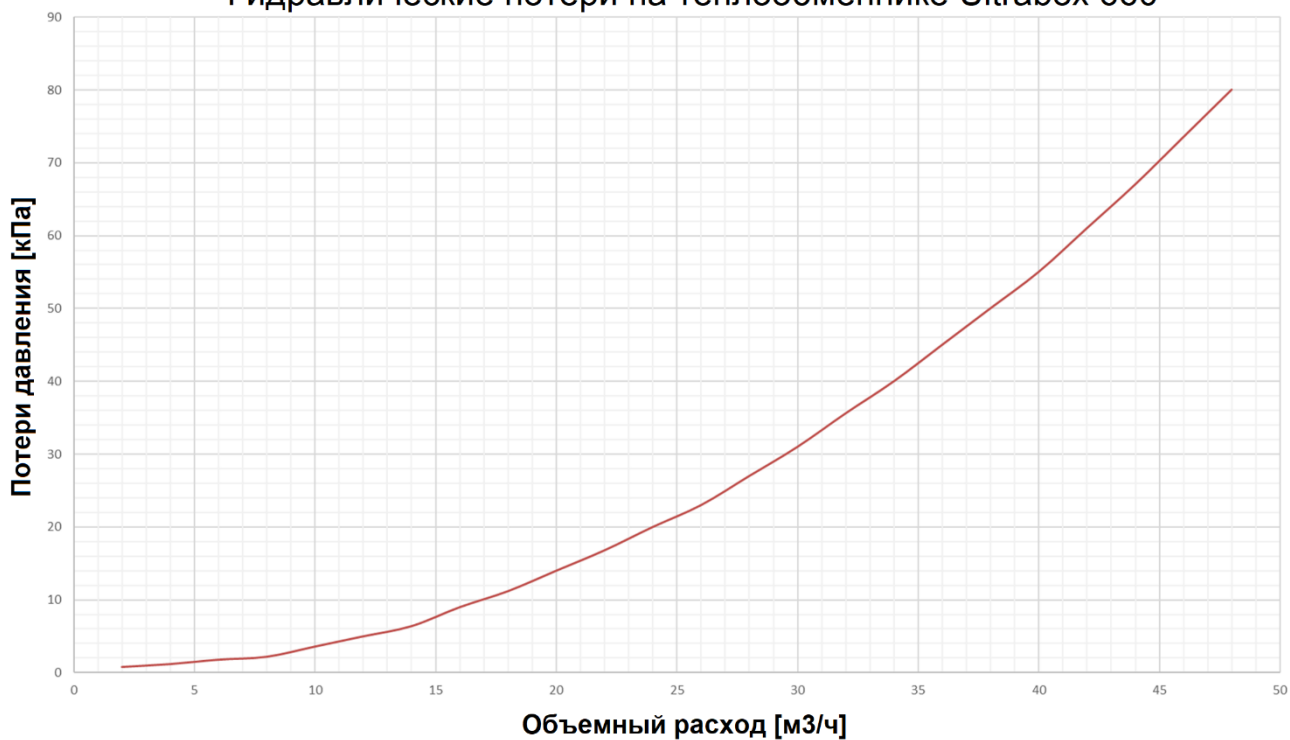
Гидравлические потери на теплообменнике Ultrabox 660
