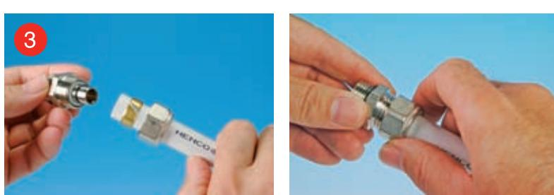
Вставьте в трубу ниппель до упора. Не повредите О -уплотнения. Соединитель из латуни должен иметь Тefлоновое кольцо, либо дополнительное О-кольцо для предотвращения электролиза. Для улучшения скольжения смажьте гайку силиконовой смазкой. Не используйте минерального масла.
