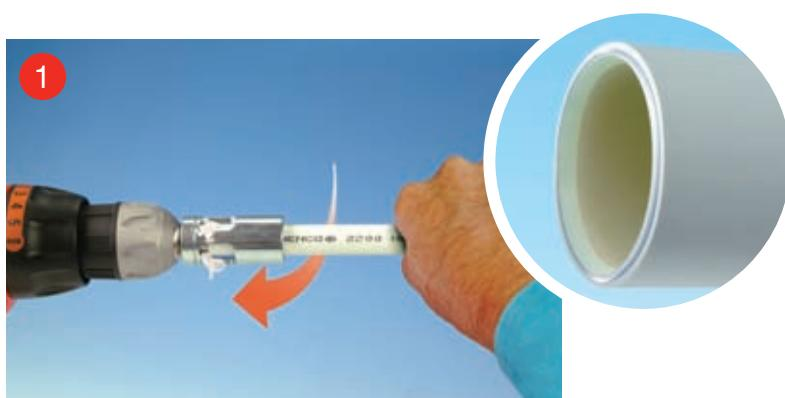
Откалибруйте трубу с помощью Henco kalispeed. Вставьте калибратор в трубу и поверните, так чтобы на конце трубы образовался конус. Конус должен быть отчетливым и равномерным.
