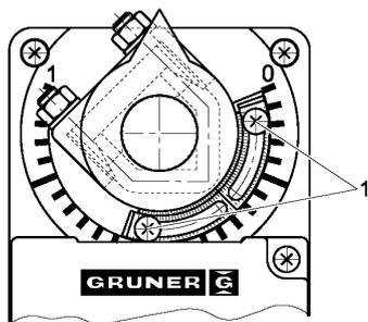
Концевые ограничители настроены на 0° и 90°. Для настройки меньших углов вращения ослабьте винты на металлических концевых ограничителях, установите концевые ограничители на требуемые значения и снова закрепите винты. Минимальный момент затягивания 1 Нм.
