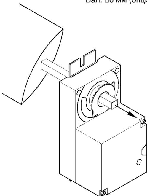
Непосредственный монтаж путем насаживания на вал клапана.
