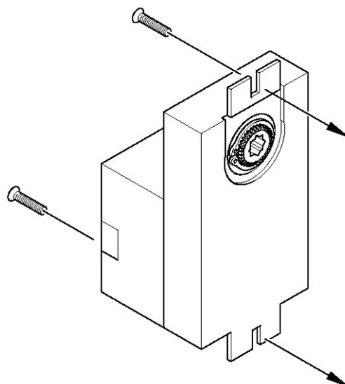
Крепление двумя фланцами с помощью винтов М5
