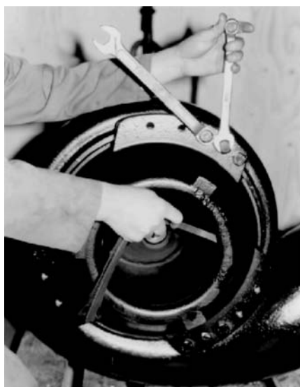
Рис. 8.5 Винты крепления патрубка во всасывающей полости и установочные винты для регулировки зазора рабочего колеса
