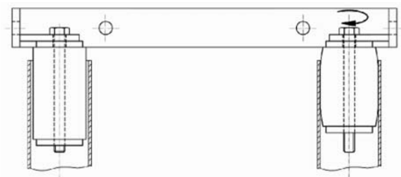
Рис. 6.6. Верхний кронштейн для крепления направляющих с разжимными болтами
