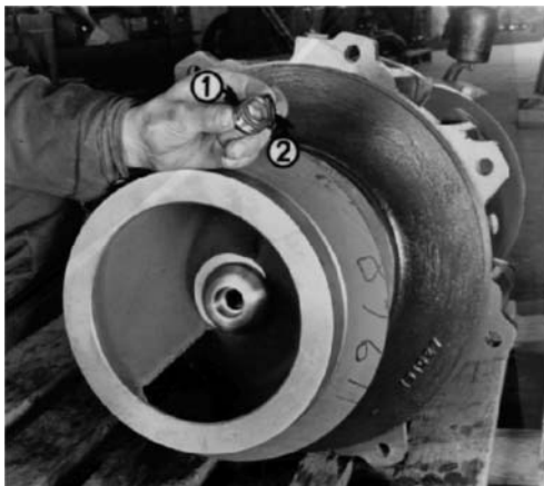
Рис. 9.1. Демонтированные детали крепления рабочего колеса. 1. Винт рабочего колеса 2. Уплотнительное кольцо винта
