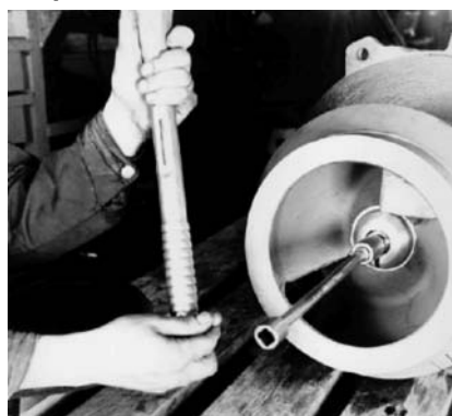
Рис. 9.3. Монтаж рабочего колеса с помощью динамометрического ключа
