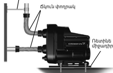
Նկար 7 SCALA2-ի աղմուկի նվազեցման համար միջոցառումներ
