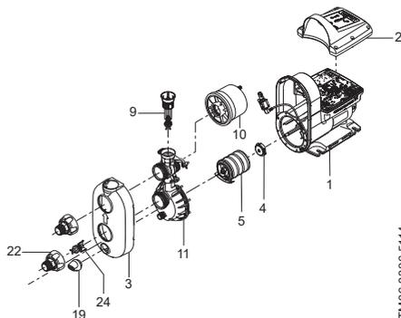
Рис. 2 Конструкция SCALA2
