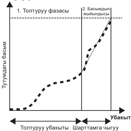
8-сүр. Түтүктөрдү жай толтуруу функциясын активдештиргенде СМВЕ ишке киргизүү
