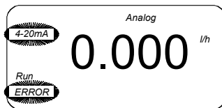
Рис. 49 Дисплей: токковый сигнал управления 4 - 20 мА
