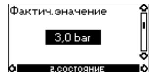
В данном окне отображается действительное значение подключенного датчика.
