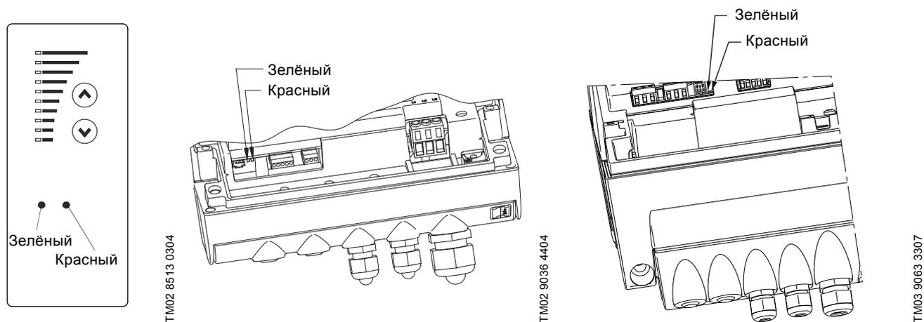
Рис. 33 Световые индикаторы на насосах с трёхфазными электродвигателями
