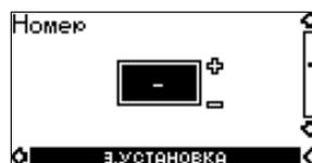
Насосу может быть присвоен номер от 1 до 64. В случае подключения к шине номер должен быть назначен каждому насосу.
