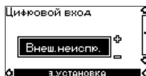
Цифровые входы насоса (клемма 1, рис. 5, 4 или 10) можно настроить на различные функции.
