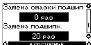
В данном окне отображается количество замен смазки подшипников электродвигателя и время, когда следует заменить подшипники.
