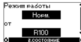
Данный экран отображает текущий режим работы ("Нормальный", "Останов", "Мин." или "Макс."). Дополнительно указано, где этот режим выбран ("R100", "Насос", "Шина", "Внешний" или "Ф-ция останова"). Дополнительную информацию о функции останова ("Ф-ция останова"), см. раздел [9.3.8 Функция останова](#).
