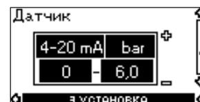
Параметры датчика должны устанавливаться только при регулируемом режиме эксплуатации.
