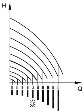
Рис. 21 Настройка производительности насоса в нерегулируемом режиме
