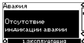
При подаче аварийного сигнала его причина выводится на дисплей.
