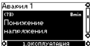
В случае возникновения неисправностей "Авария" в журнале аварий отобразятся пять последних аварийных сигналов.
