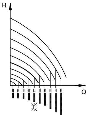
Рис. 15 Насос в нерегулируемом режиме (постоянная характеристика)
