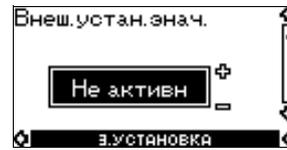
Вход для внешнего сигнала задания уставки может быть настроен на разные типы сигналов.
