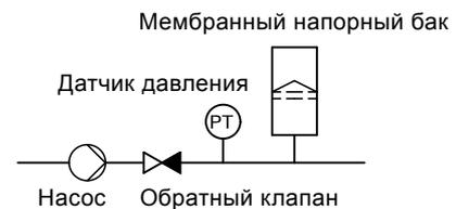
**Рис. 26** Положение обратного клапана и датчика давления в системе с избыточным давлением на входе
