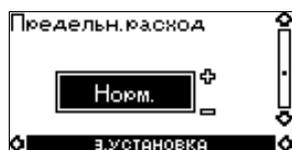
Для того чтобы определить, при каком значении расхода система должна переходить из непрерывного рабочего режима при постоянном давлении к режиму пуска/останова, необходимо выбрать одно из четырёх значений, три из которых представляют собой предварительно заданные предельные значения расхода:
