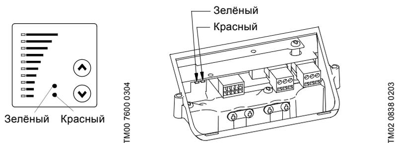
Рис. 32 Световые индикаторы на насосах с однофазными электродвигателями
