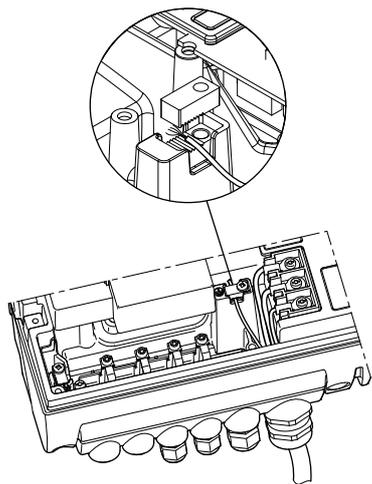
**Рис. 7** Соединение отдельным защитным проводом с использованием одного проводника 4-жильного силового кабеля (с поперечным-сечением минимум 10 мм<sup>2</sup>)
