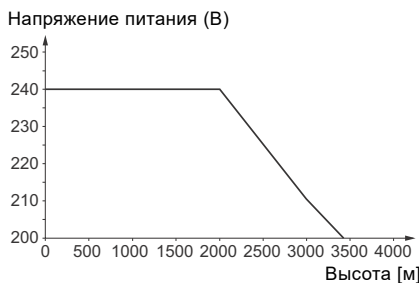
Рис. 15 Напряжение питания для однофазного электродвигателя в зависимости от высоты над уровнем моря
