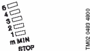
Рис. 14 Набор световых индикаторов хх-60
