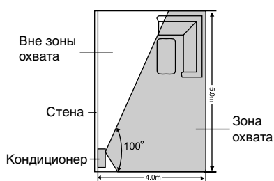
Кондиционер установлен в левой стороне комнаты
