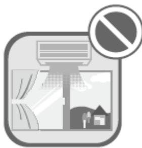
Если в том же помещении, где установлен кондиционер, используется газовый или бензиновый обогреватель, необходимо открыть дверь или окно для обеспечения нормальной циркуляции воздуха, в противном случае в помещении может возникнуть нехватка кислорода.
