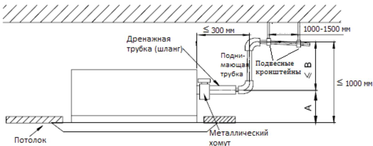
Высота поднимающей трубки не должна превышать 850 мм. Если поднимающая трубка располагается вертикально относительно внутреннего блока, то ее высота не должна превышать 800 мм (на рисунке 675 мм), расстояние между ней и внутренним блоком должно быть менее 300 мм.
