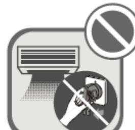
Запрещается начинать работу кондиционера, подключая вилку питания к розетке, или останавливать его работу, вынимая вилку из розетки.
