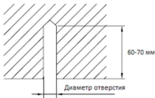
1. Приклейте трафарет на место установки внутреннего блока. Просверлите 4 отверстия в потолке в соответствии с обозначениями. Диаметр отверстий должен соответствовать диаметру подвесных болтов, глубина отверстий – 60-70 мм.
