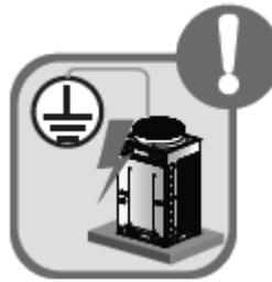
Блоки системы должны быть надежно заземлены. Запрещается подключать провод заземления к газовой или водопроводной трубе, либо телефонной линии.
