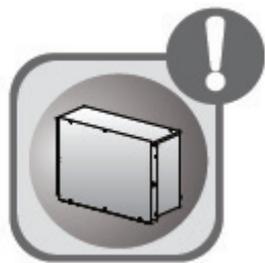
После подключения кабеля питания установите на место крышку электромонтажного короба во избежание опасности.
