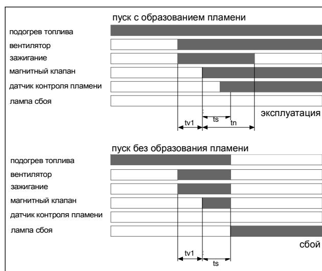
ts - контрольно-предохранительный период
