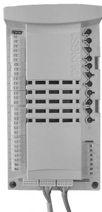
МРА 22 – топочный автомат с микропроцессорным управлением сервопривода, для контроля и управления пневмо-модулирующей горелкой и с интегрированным прибором контроля герметичности клапанов. Топочный автомат МРА 22 оснащён шиной передачи данных e-BUS. При непрерывной работе в течении 24 часов блок управления МРА 22 выключает горелку на короткое время (20-30 сек.) для проверки всех установок, включая проверку герметичности клапанов.
