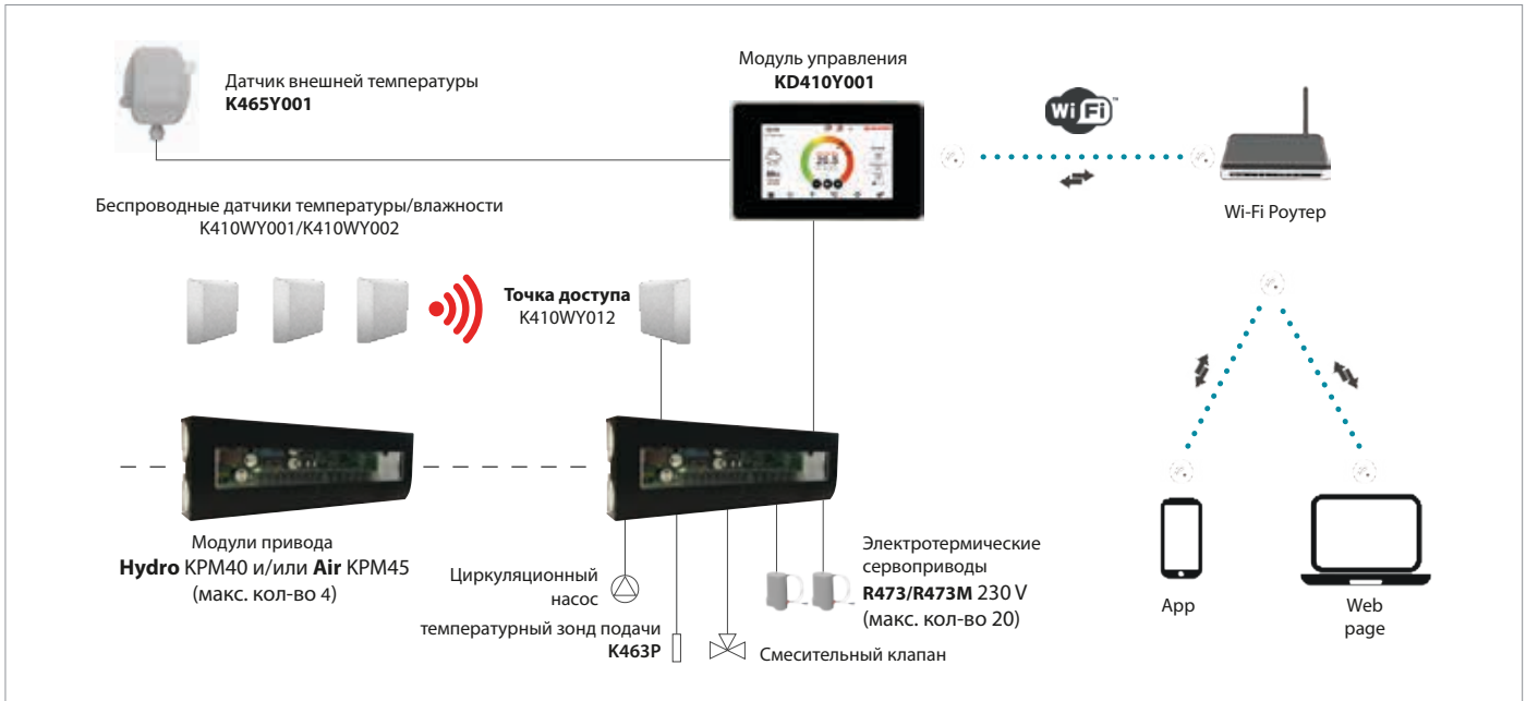
Схема взаимодействия компонентов системы автоматического беспроводного управления системой панельного отопления на базе модуля KD410Y001
