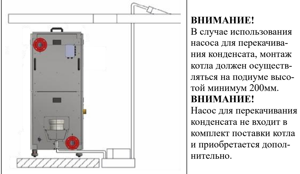
Схема отвода конденсата с насосом для перекачивания конденсата
