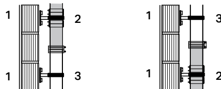
Рисунок 60: Переход с обжимным хомутом Geberit, для Geberit HDPE – всегда с опорным кольцом
