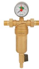
Обладает функциями фильтрации и промывки. С помощью дренажного крана осуществляется прямоточная промывка фильтра, в результате чего загрязнения не поступают в обработанную воду, а остаются снаружи фильтрующего элемента на дне колбы. С поверхности фильтрующего элемента и со дна колбы загрязнения удаляются во время промывки.
