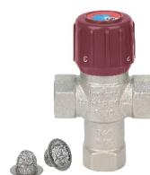
Терmostатические смесительные клапаны для систем отопления и ГВС. Служат для поддержания постоянной температуры смешанной воды для пользования, в том числе и в случае изменения температуры и напора на входе горячей и холодной воды.
