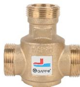
Терmostатические смесительные клапаны это терmostатические клапаны с боковым смесителем, используемые в отопительных системах с твердотопливным теплогенератором. Это системы с котлами, работающими на древесине, пеллетах, деревянной щепе. Их функция заключается в поддержании температуры теплоносителя на фиксированном значении, с помощью подмешивания холодного теплоносителя.
