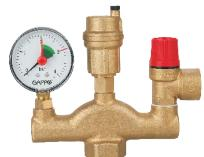
Группа безопасности котла комплектуется автоматическим поплавковым воздухоотводчиком, предохранительным клапаном 3 бар и манометром.
