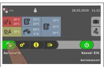
Je nach Kesseltype stehen mehrere Betriebsarten zur Verfügung, welche direkt am Grundbild des Touchdisplays geändert werden können.
