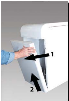
рис. 5 - Открытие передней панели.
