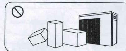
1.4.4. Невставляйте посторонние предметы в отверстия для выхода воздуха. В противном случае это может привести к снижению производительности теплового насоса или даже к его остановке.
