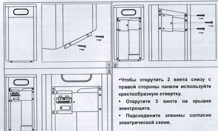
Примечание: для подключения питания модели IPH28/35 необходимо открыть заднюю панель. Производить процедуру подключения согласно указанному выше.
