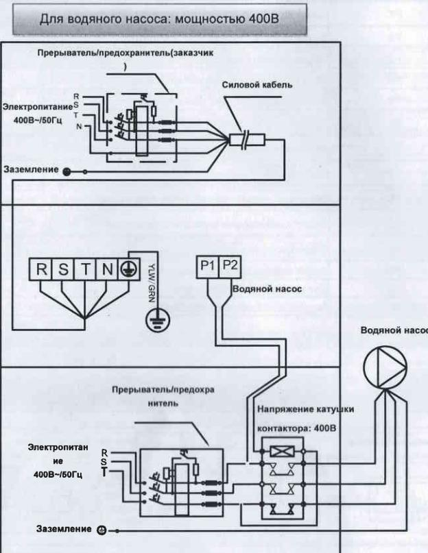
Параллельное соединение с таймером фильтрации
