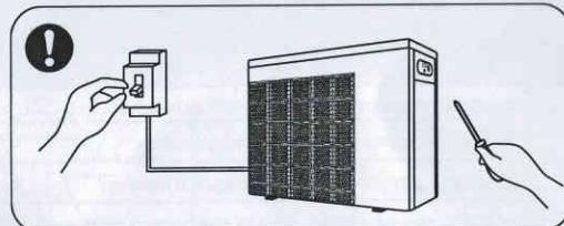
• Перед проведением чистки, осмотра и ремонта необходимо отключить электропитание. Запрещается касаться электрических элементов, до тех пор, пока не погаснет светодиодный индикатор на блоке управления процессом.
