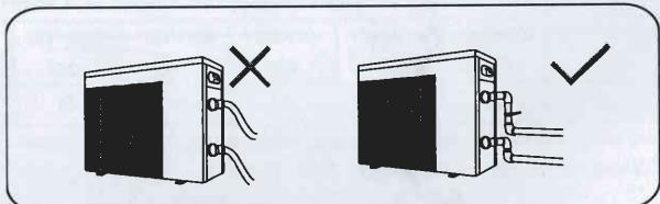
2.1.2. Для обеспечения гарантированной теплопроизводительности длина водопровода должна составлять ≤ 10 м между бассейном и теплонасосом.
