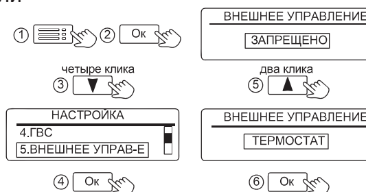
Рисунок 19. Настройка работы от внешнего устройства
