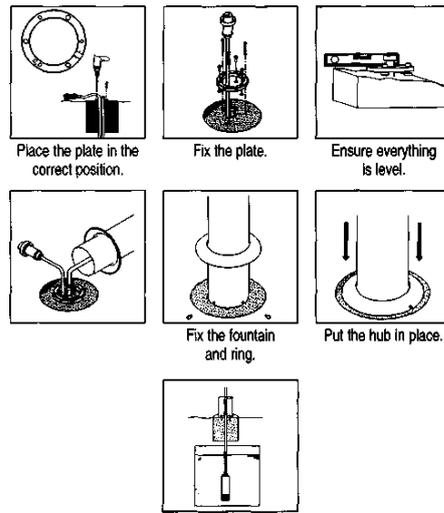
Рис1.Правильно разложите диск. Рис2.Закрепите диск. Рис3.Убедитесь, что все закреплено ровно. Рис4.Будьте осторожны, чтобы не повредить проводам. Рис5.Закрепите диск и сам распыриватель. Рис6. Отпустите на место кольцо. Рис7. Стабилизируйте насос.
