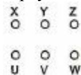
Расположение обмоток двигателя
