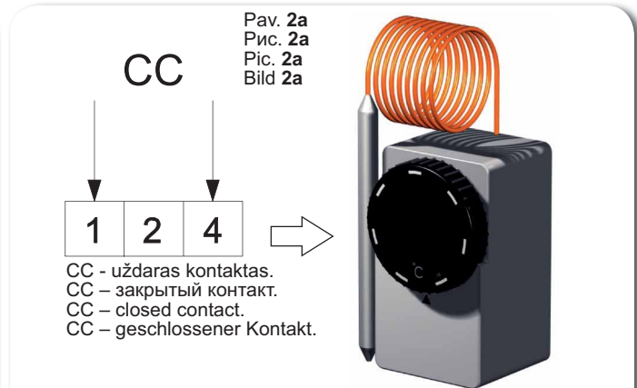
Priešušaliminio termostato patikrinimas. Проверка противозаморающего термостата. Inspection of the antifreeze thermostat. Überprüfung des frostbeständigen Thermostates.
