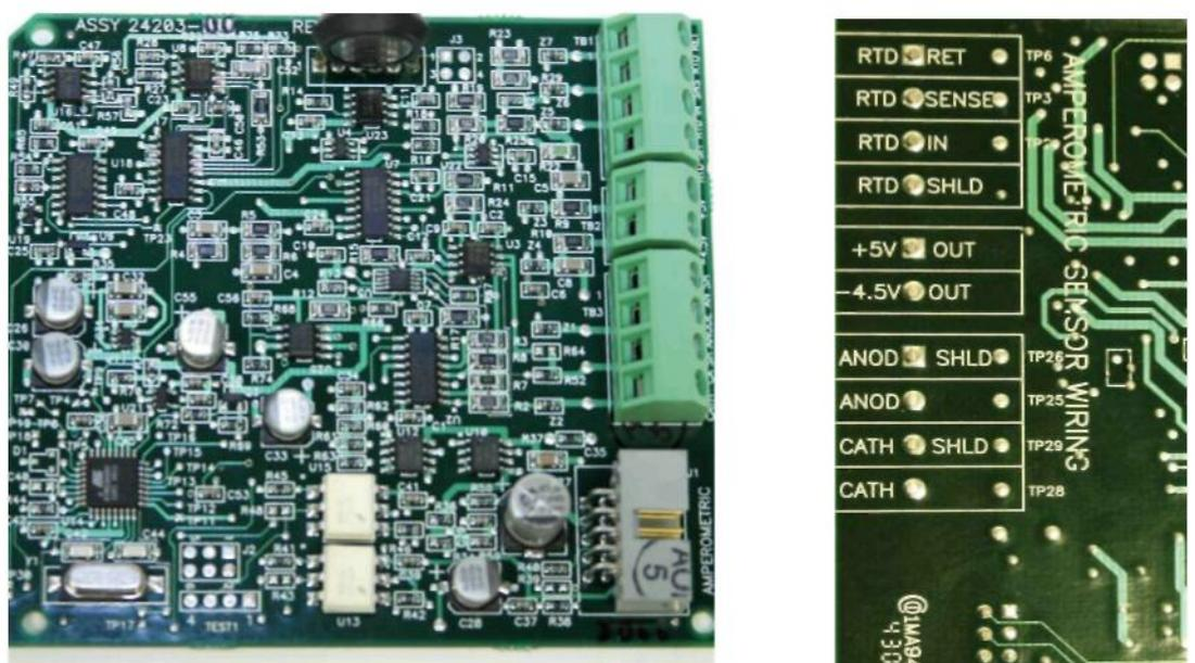
Рис. 3-10. Плата ввода сигналов мутности со штекерным подключением датчика
