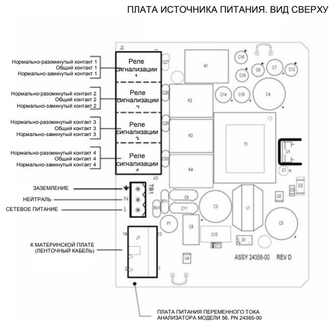
Рис. 3-3. Разводка выходных сигналов на материнской плате PN 24308-00 анализатора модели 56
