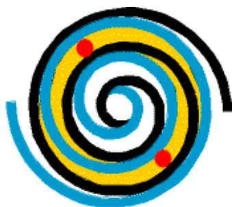
Рис 2: Порты впрыска пара и трубные соединения в спиральном блоке
