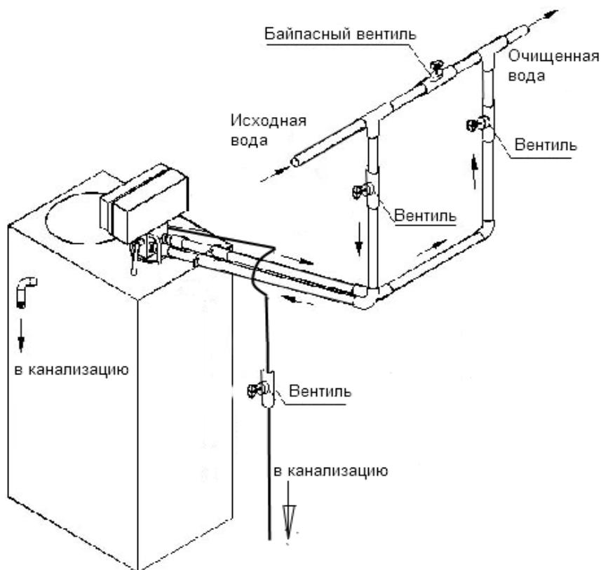
Рисунок 2 – Схема монтажа установки удаления железа и умягчения воды WSDF(C)-1,3-CI-(MIX C)
