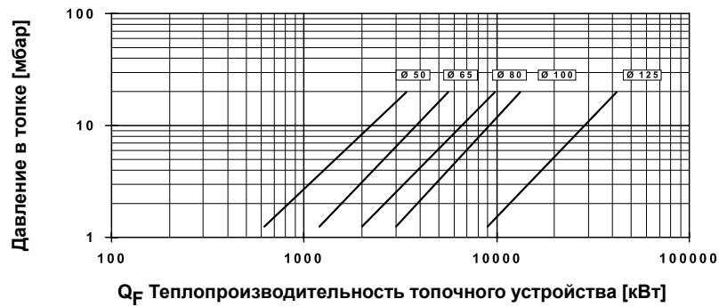
Потеря давления в газовой арматуре (полностью раскрытой) DN 150, природный газ
