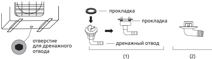
**ПРИМЕЧАНИЕ:** изображение конструкции дренажного патрубка приведено для справки. Конструкция дренажного патрубка вашего кондиционера может отличаться (например, может отсутствовать резиновая прокладка).
